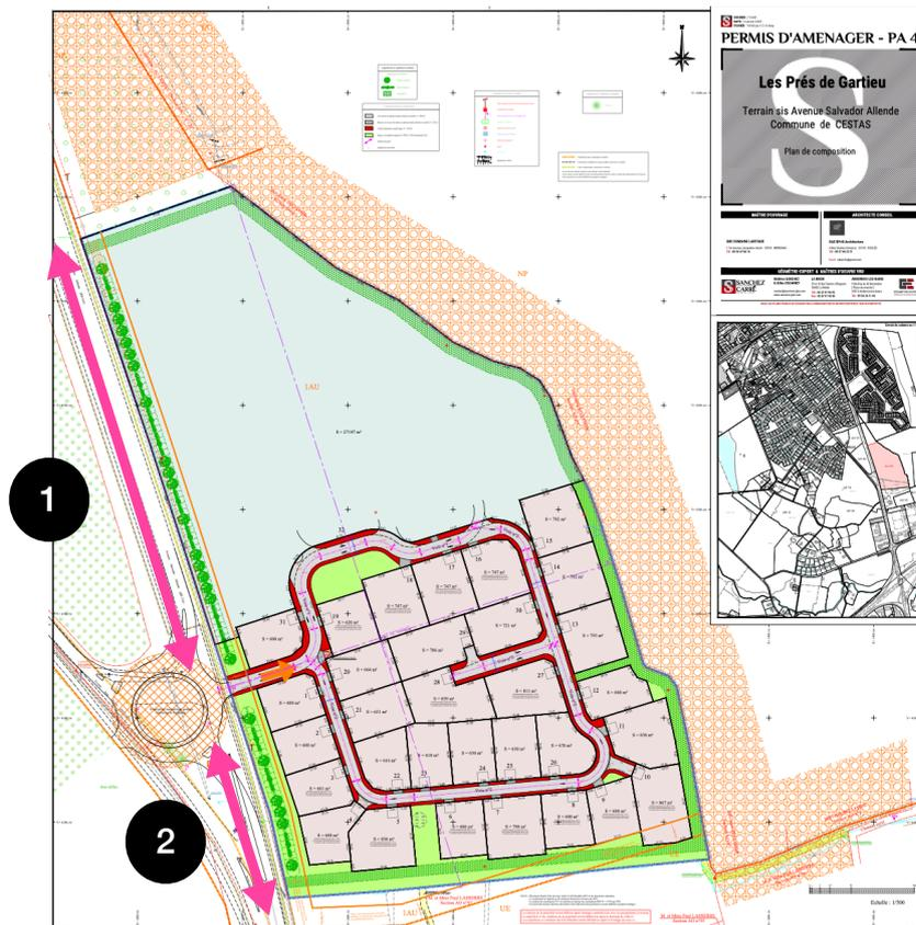
**La demande de la préfecture de la mise en place d'une piste périmétrale de 5 m de largeur n'est pas respecté.**
