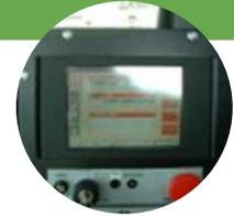
**i** Les véhicules sont équipés du système WAVE permettant le relevé d'informations terrain en automatique (relevés GPS, heures de travail, kilométrage, bacs relevés, bacs cassés, incidents de collecte, etc.).
